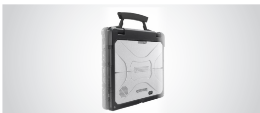
Защищённый гибридный ноутбук (IP65/MIL-STD 810G) для работы в экстремальных условиях (-30 °С)
